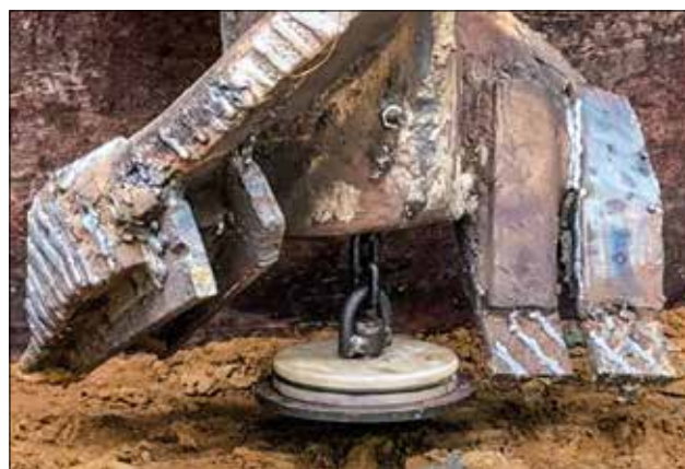
FIGURA 4 EXTREMIDADE INFERIOR DO TRADO DA HÉLICE CONTÍNUA
