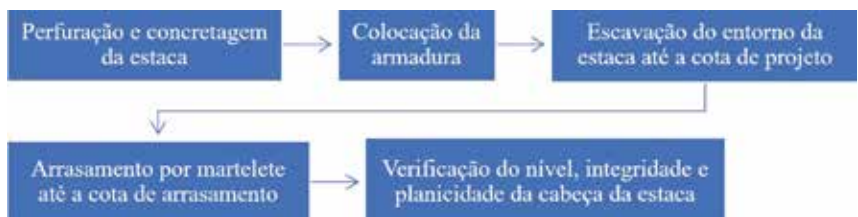
FIGURA 8 PROCEDIMENTOS EXECUTIVOS DE ARRASAMENTO POR MARTELETE
